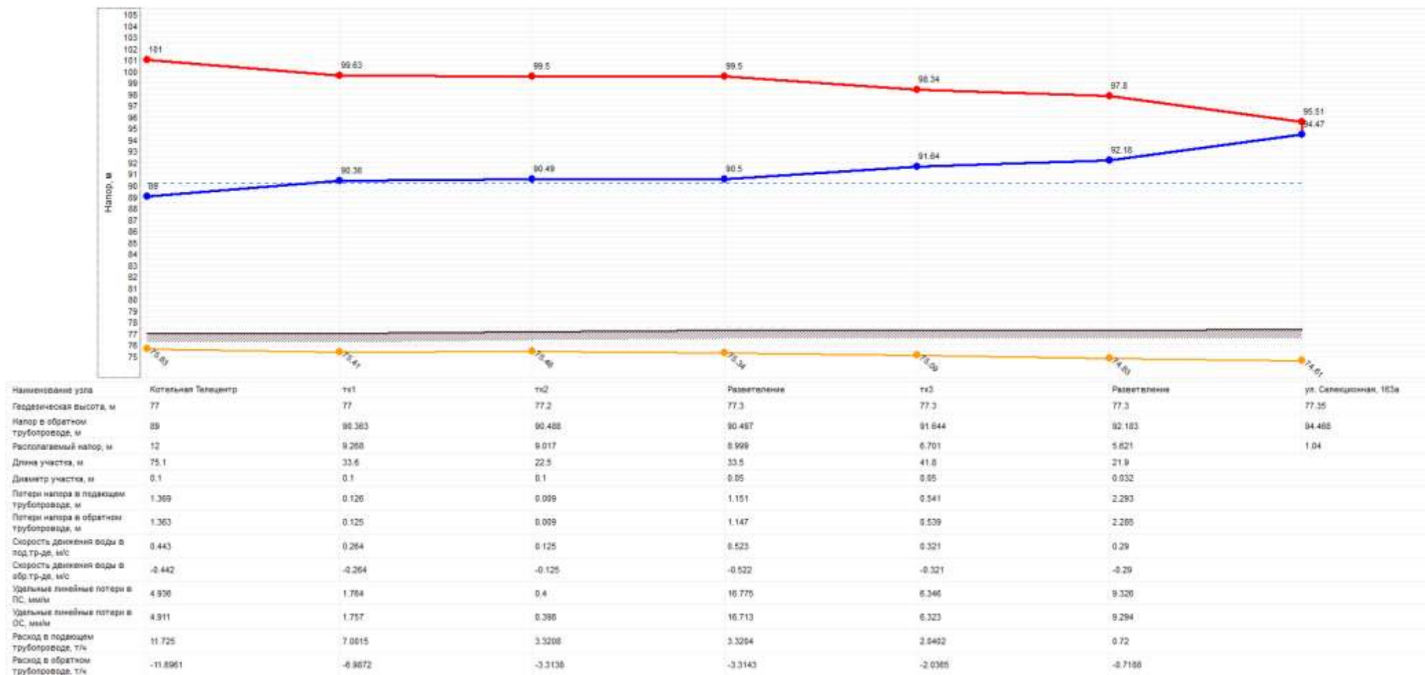
Пьезометрический график от котельной «Телецентр» до самого удаленного потребителя.
