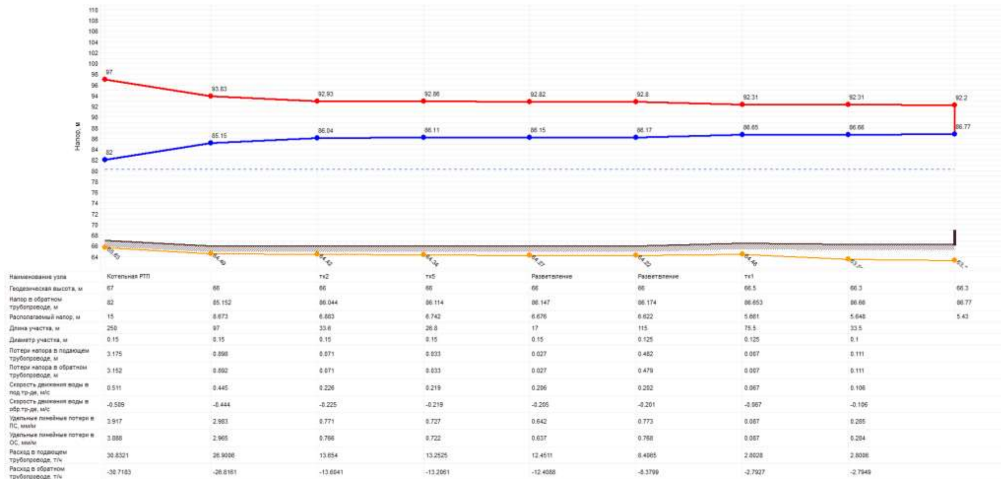
Пьезометрический график от котельной «РТП» до самого удаленного потребителя.
