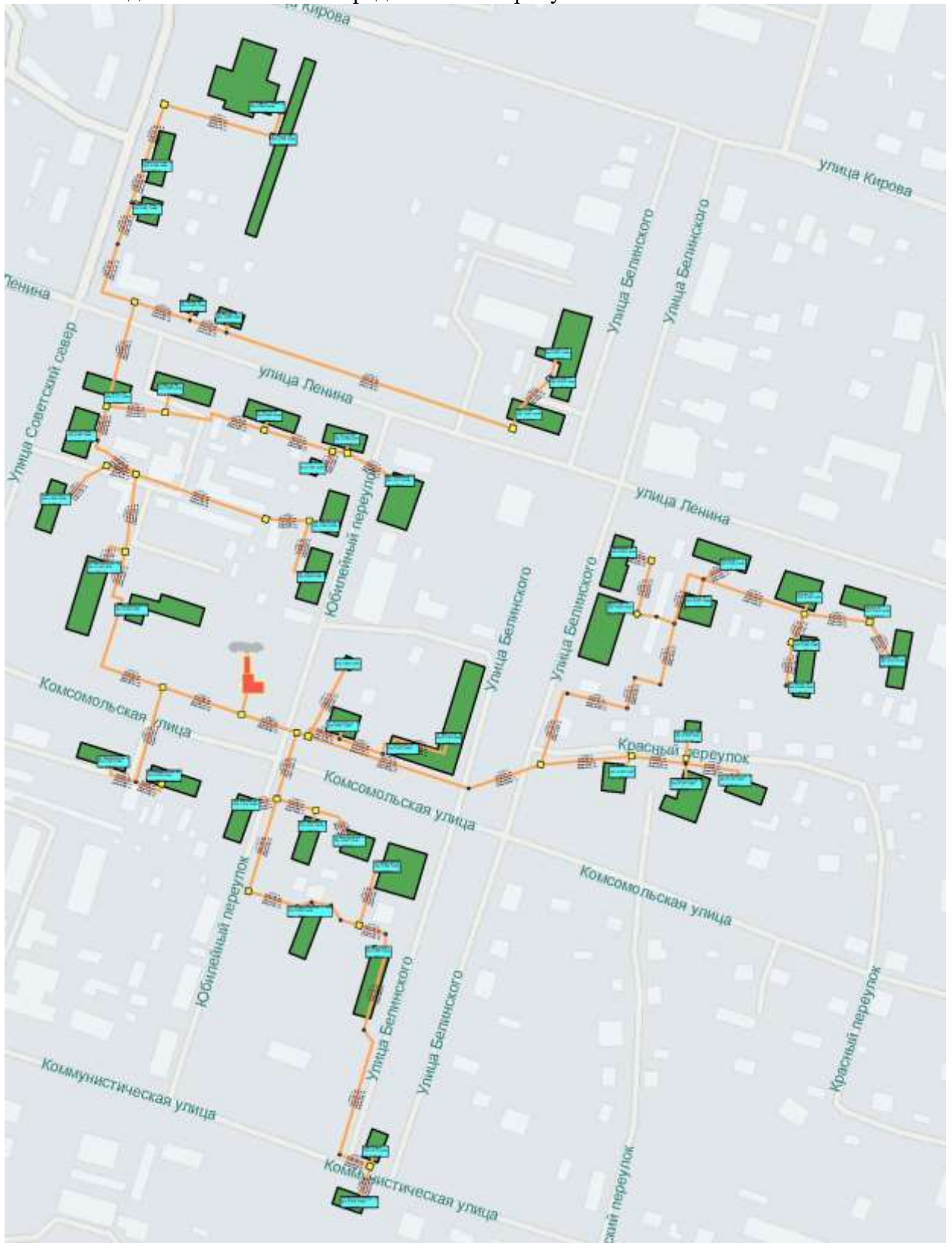
Рисунок 90. Зона действия котельной «Педучилище».
