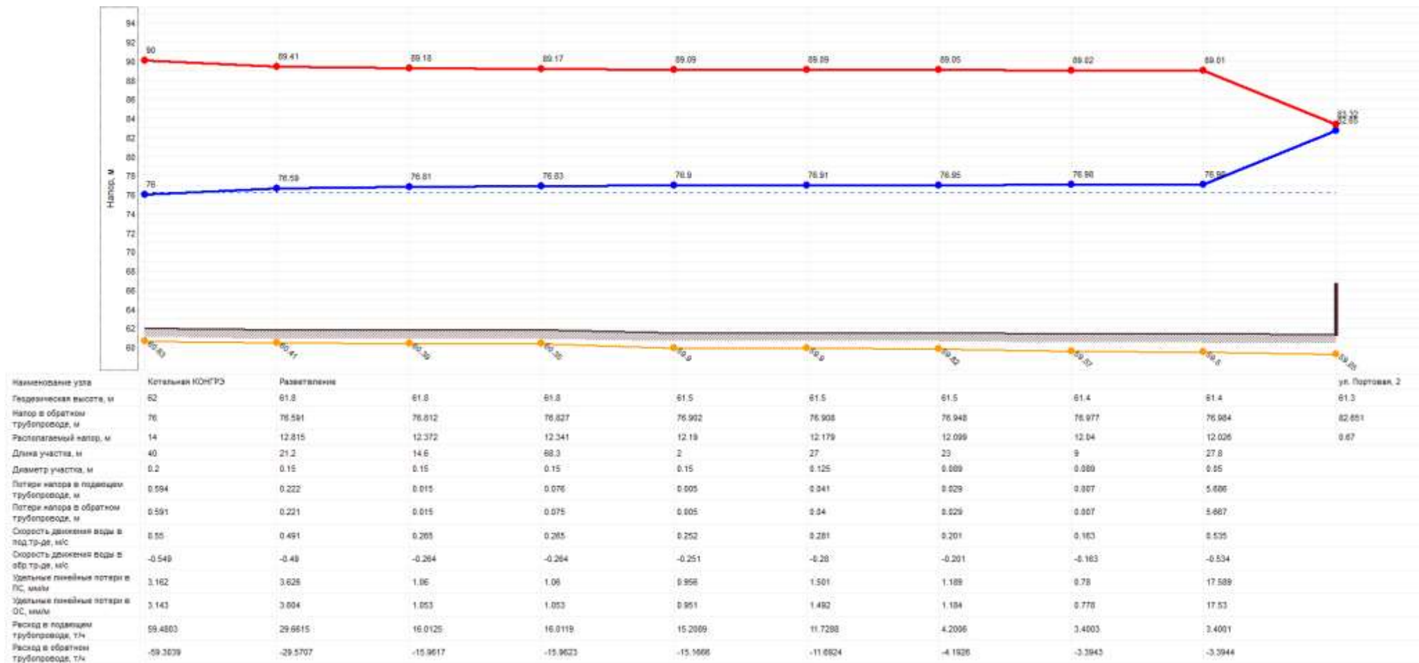
Рис. 62 Пьезометрический график от котельной «КОНГРЭ» до жилого дома по адресу ул. Портовая 2.
