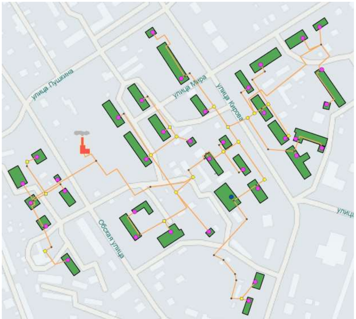
Рисунок 13. Зона действия котельной «ДПО».
