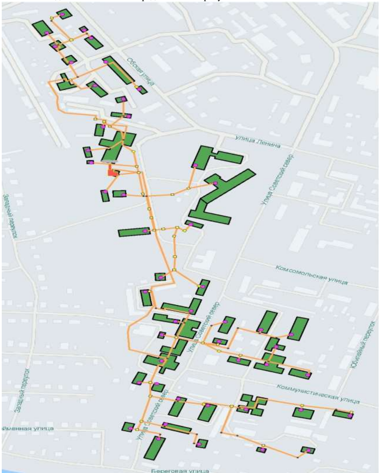
Рисунок 13. Зона действия котельной «ЦРБ».
