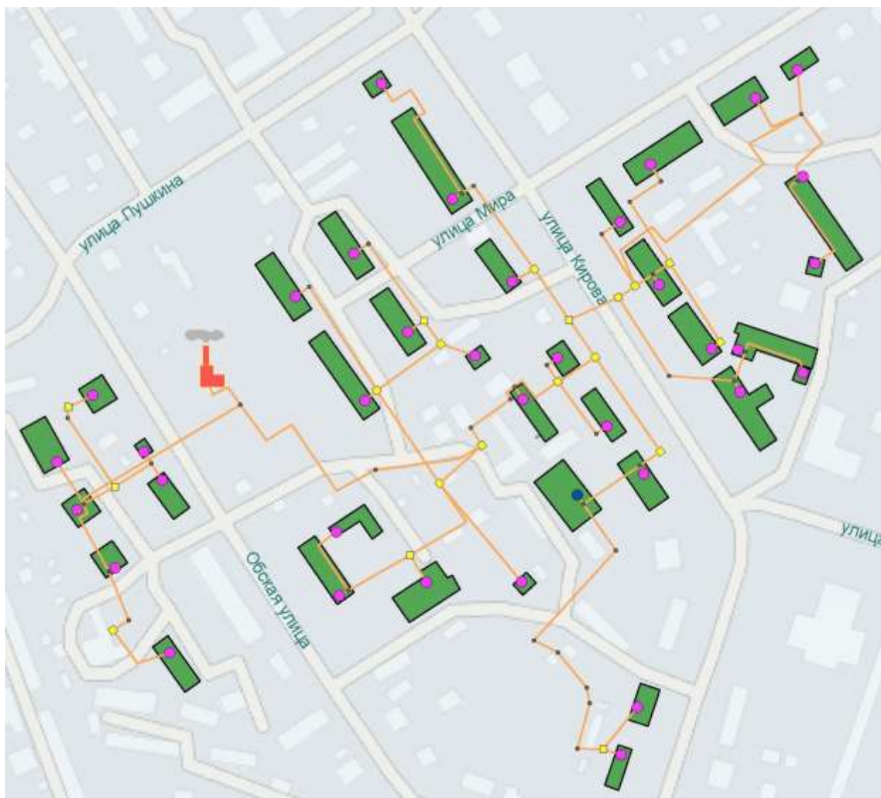
Рисунок 36. Схема тепловых сетей котельной «ДПО».
