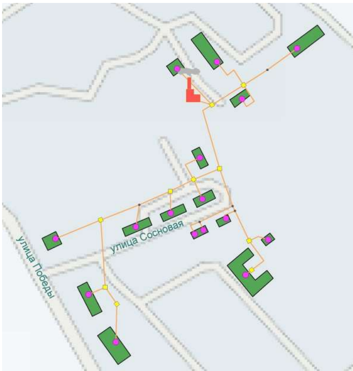
Рисунок 30. Схема тепловых сетей котельной «Урожай».
