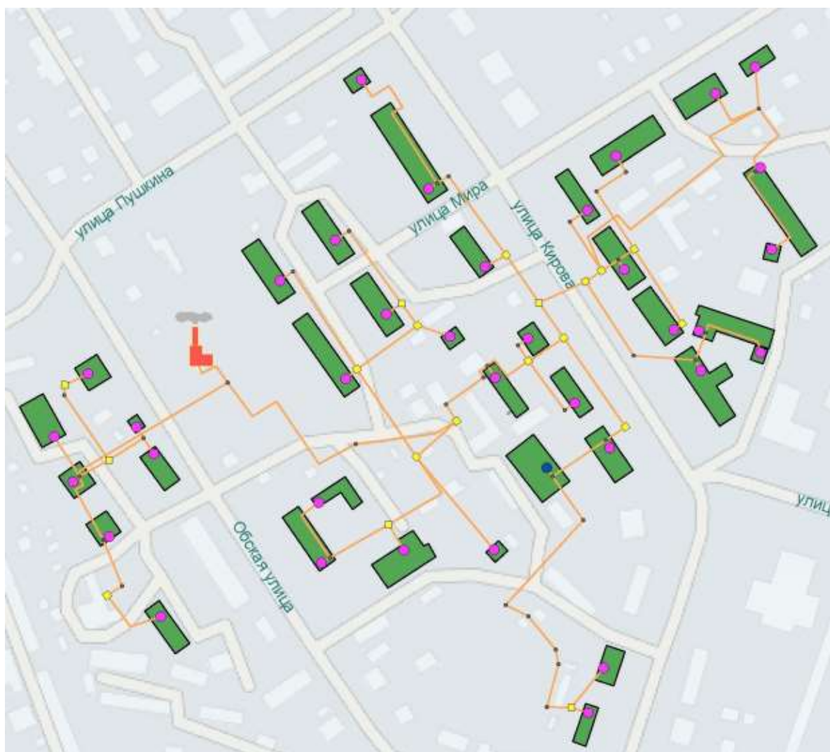
Рисунок 12. Зона действия котельной «ДПО».
