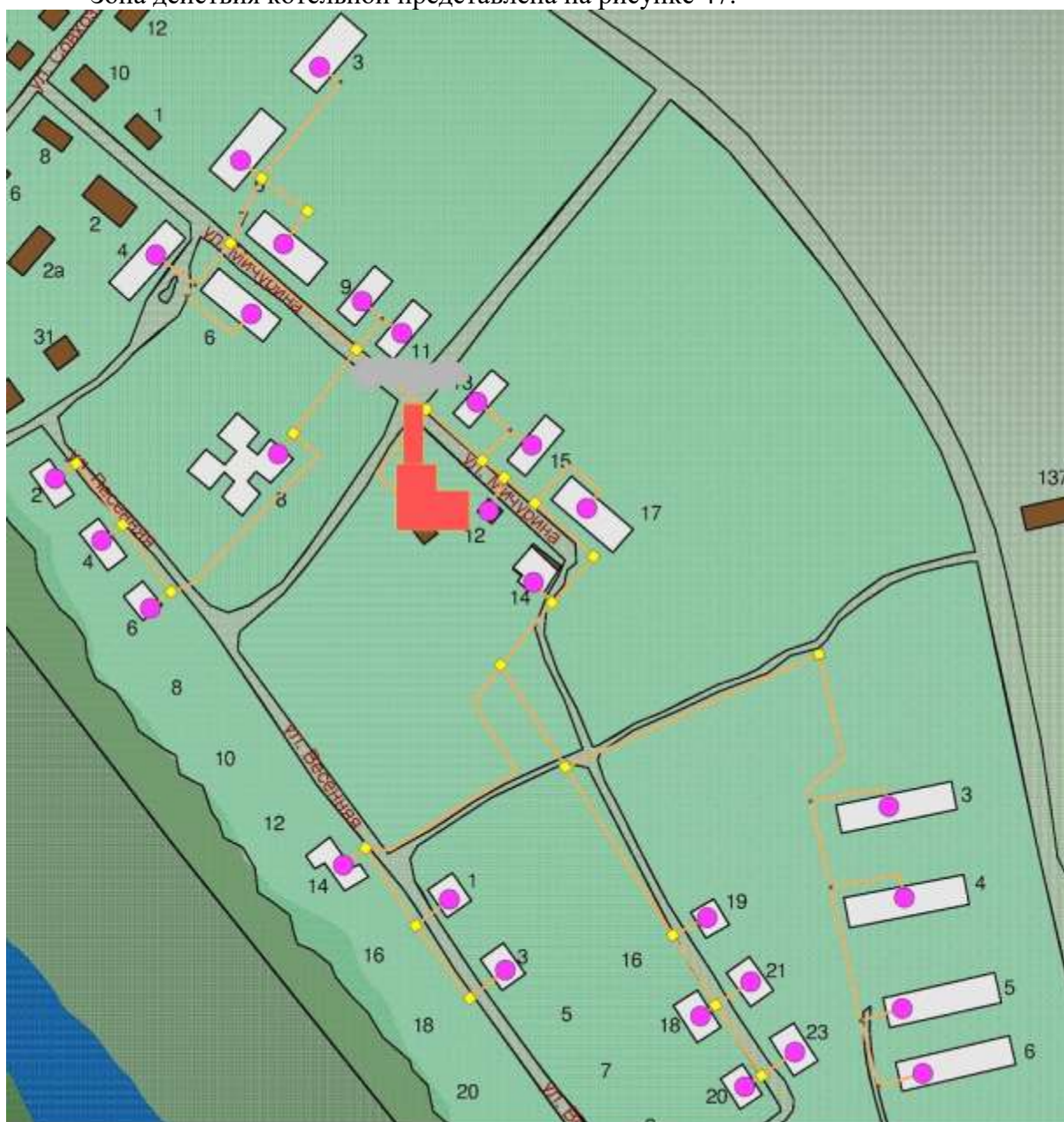
Рисунок 44. Схема тепловых сетей котельной «Совхозная».
