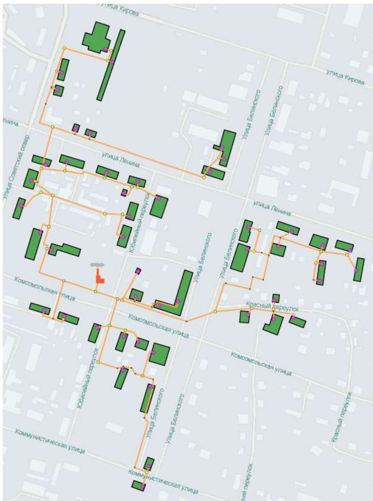
Рисунок 35. Схема тепловых сетей котельной «Педучилище».
