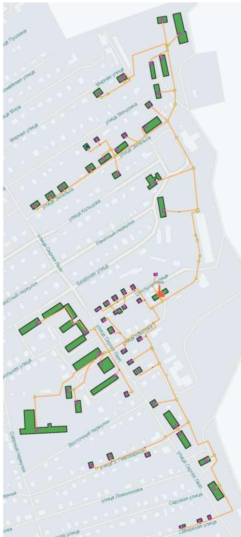
Рисунок 26. Схема тепловых сетей котельной Лазо.
