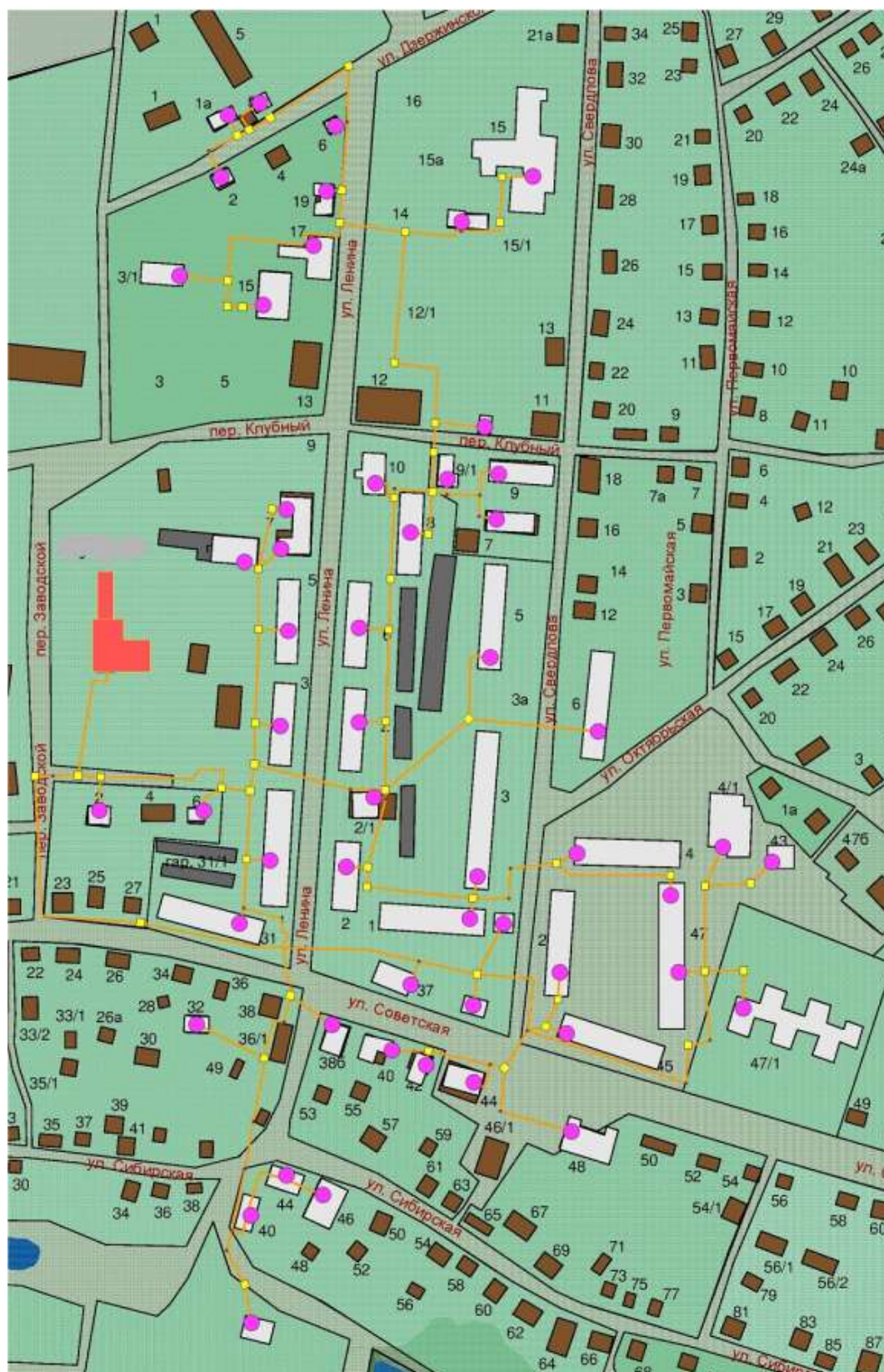
Рисунок 45. Схема тепловых сетей котельной «Заводская».
