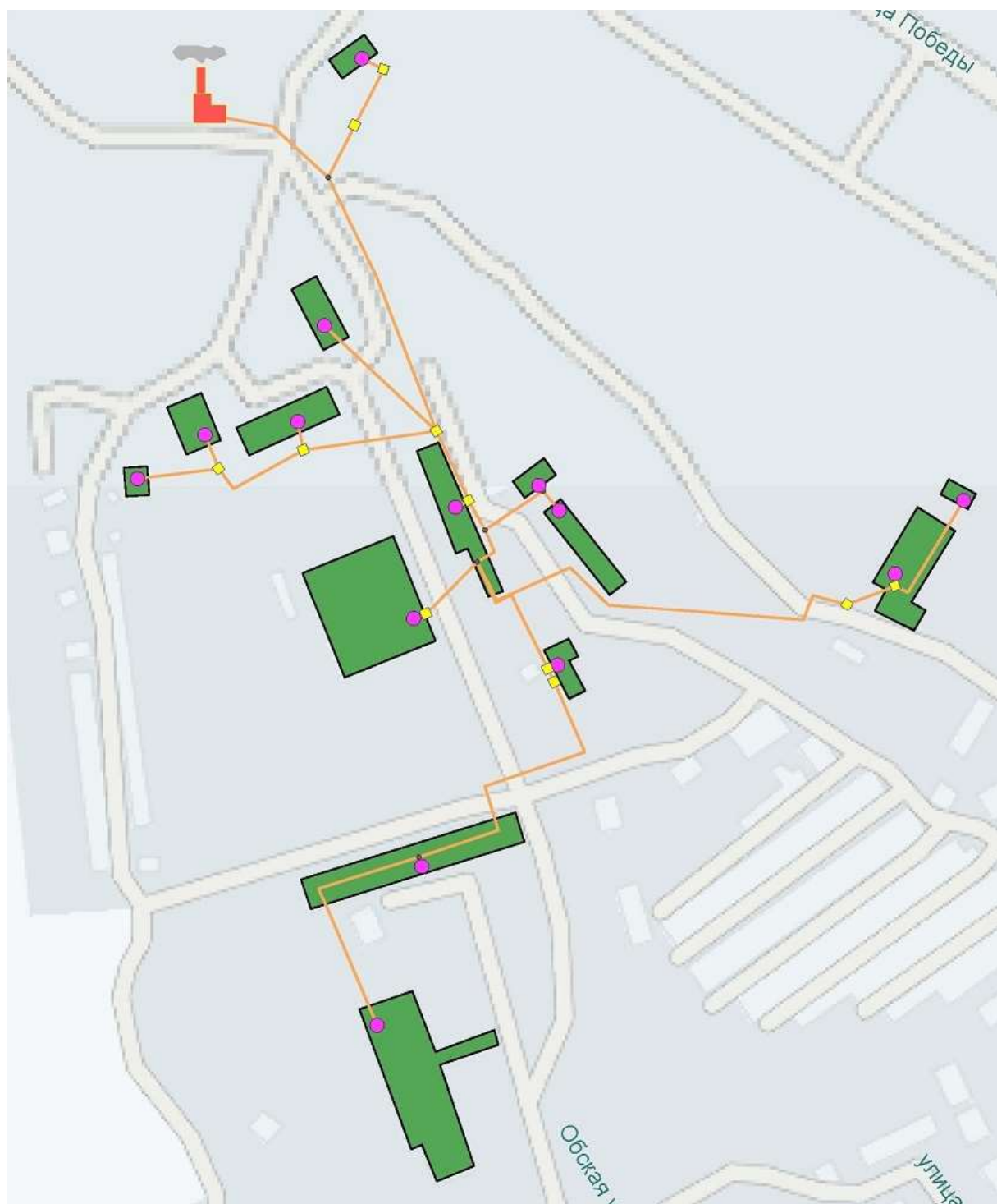
Рисунок 14. Зона действия котельной «РТП».
