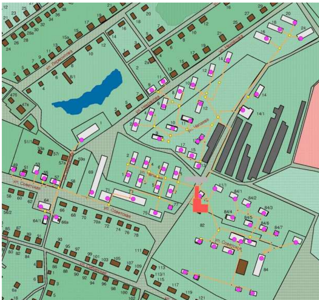
Рисунок 42. Схема тепловых сетей котельной «Детский дом».
