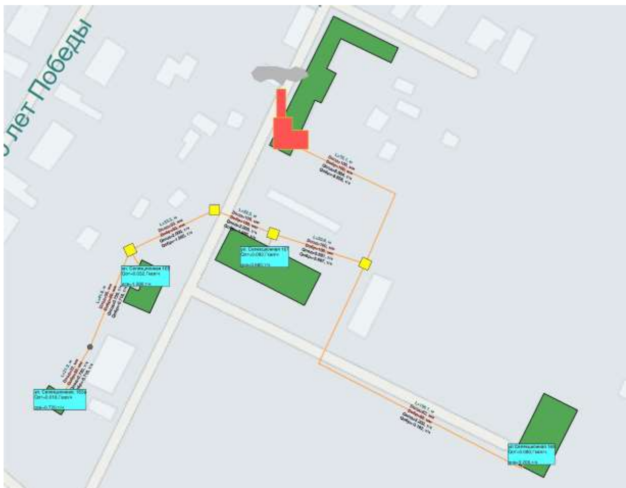
Рисунок 79. Зона действия котельной «Телецентр».
