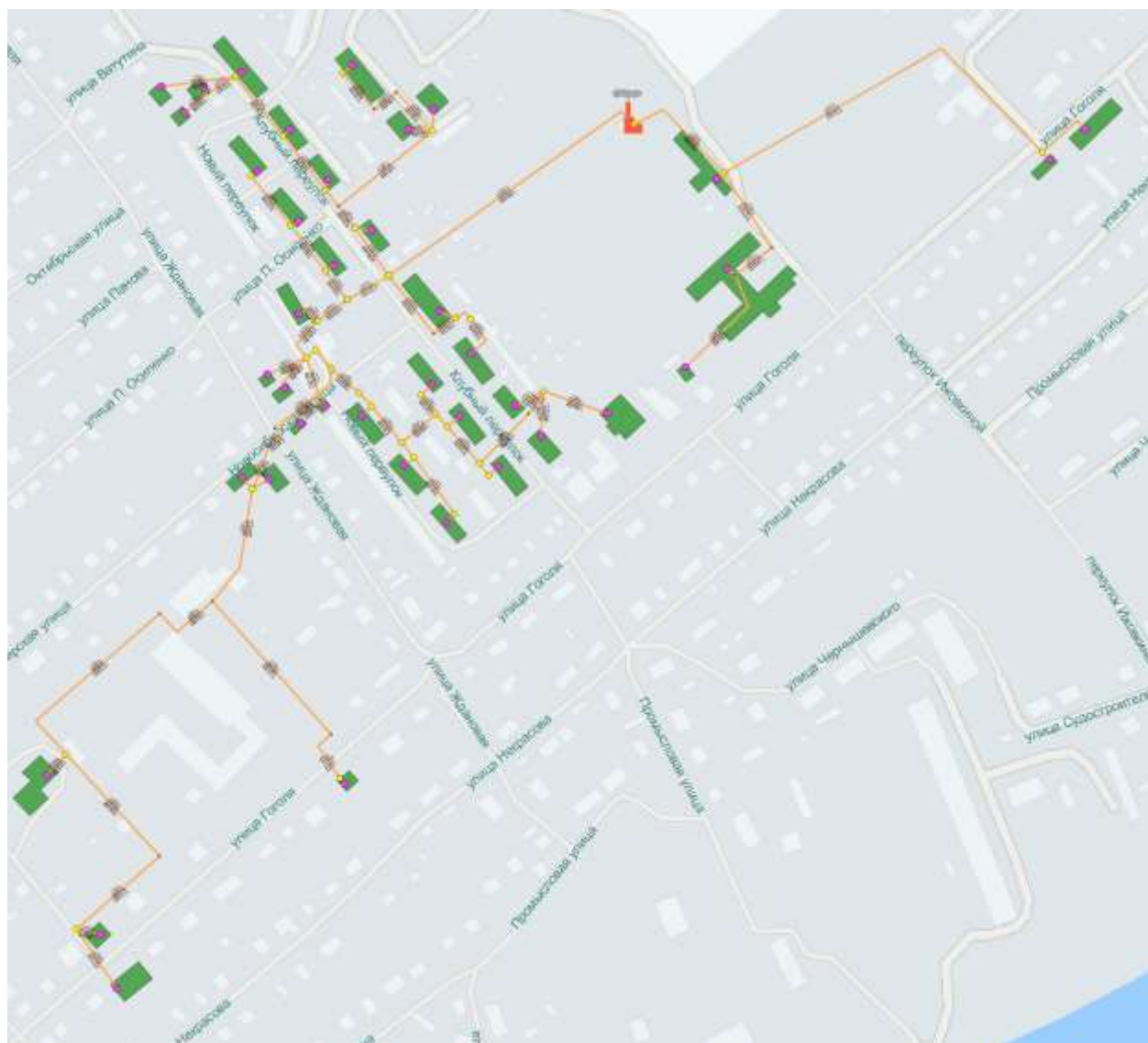
Рисунок 31. Схема тепловых сетей котельной «Школа».
