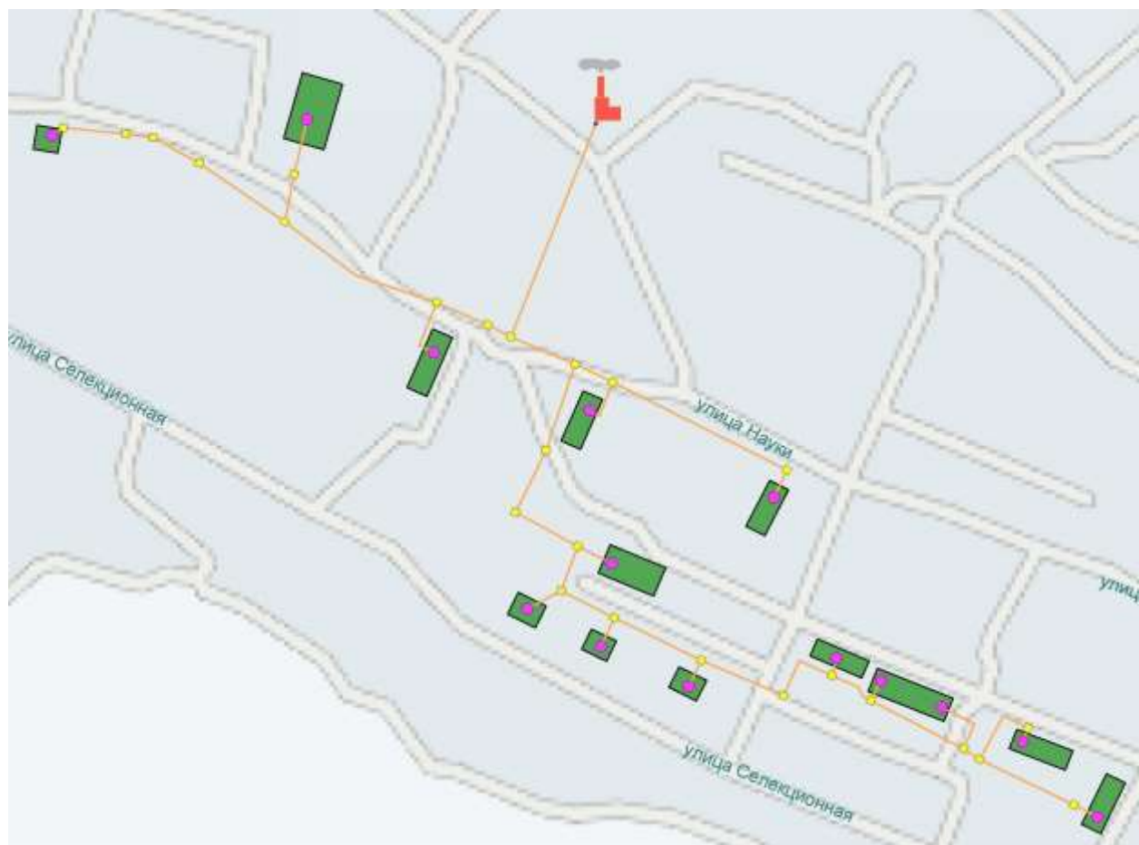
Рисунок 27. Схема тепловых сетей котельной НГСС.
