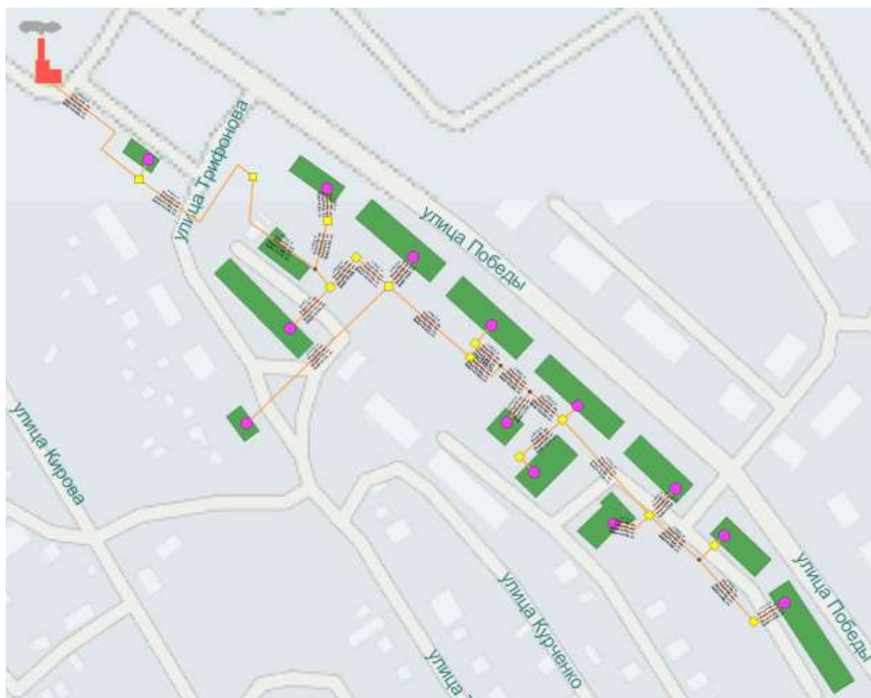
Рисунок 25. Схема тепловых сетей котельной «Звезда».
