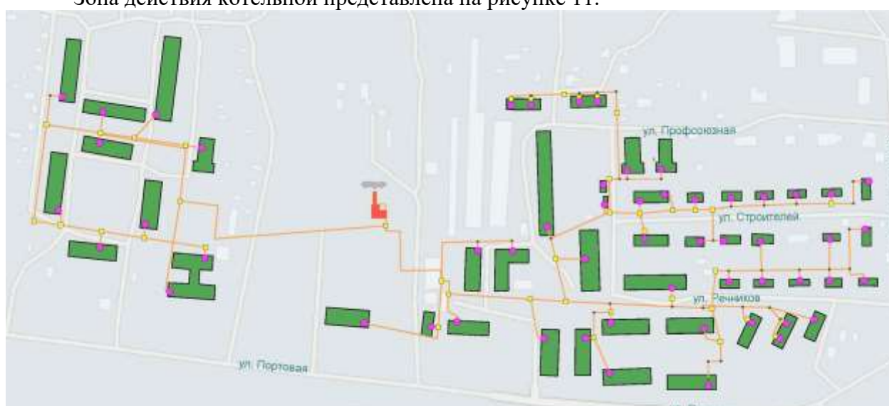
Рисунок 10. Зона действия котельной «Речников».
