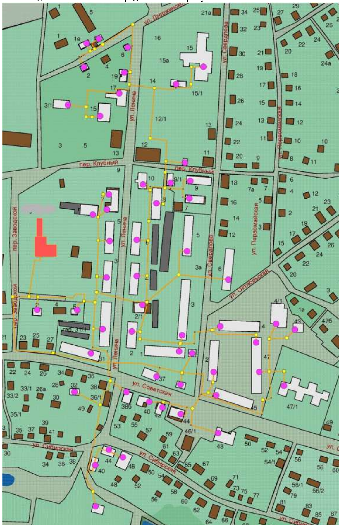
Рисунок 21. Зона действия котельной «Заводская».
