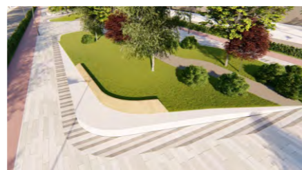
БЕТОННАЯ ПОДПОРНАЯ СТЕНКА С МЕСТОМ ДЛЯ СИДЕНИЯ
