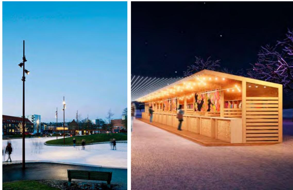
Освещение важная составляющая безопасности и комфортности пространства. Опоры с несколькими светильниками установлены с шагом 15 метров, что дает хорошее пятно освещения на всей протяженности маршрута. Планируется устройство освещения территории светильниками со встроенными колонками для проигрывания музыки и анонсирования планируемых мероприятий на территории сквера. Освещение включается автоматически при срабатывании датчика освещенности.
