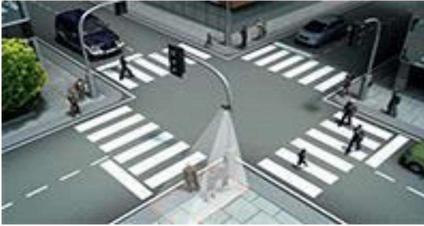
Рисунок 14. Обнаружение пешеходов оптическим датчиком и активация предупредительной световой сигнализации
