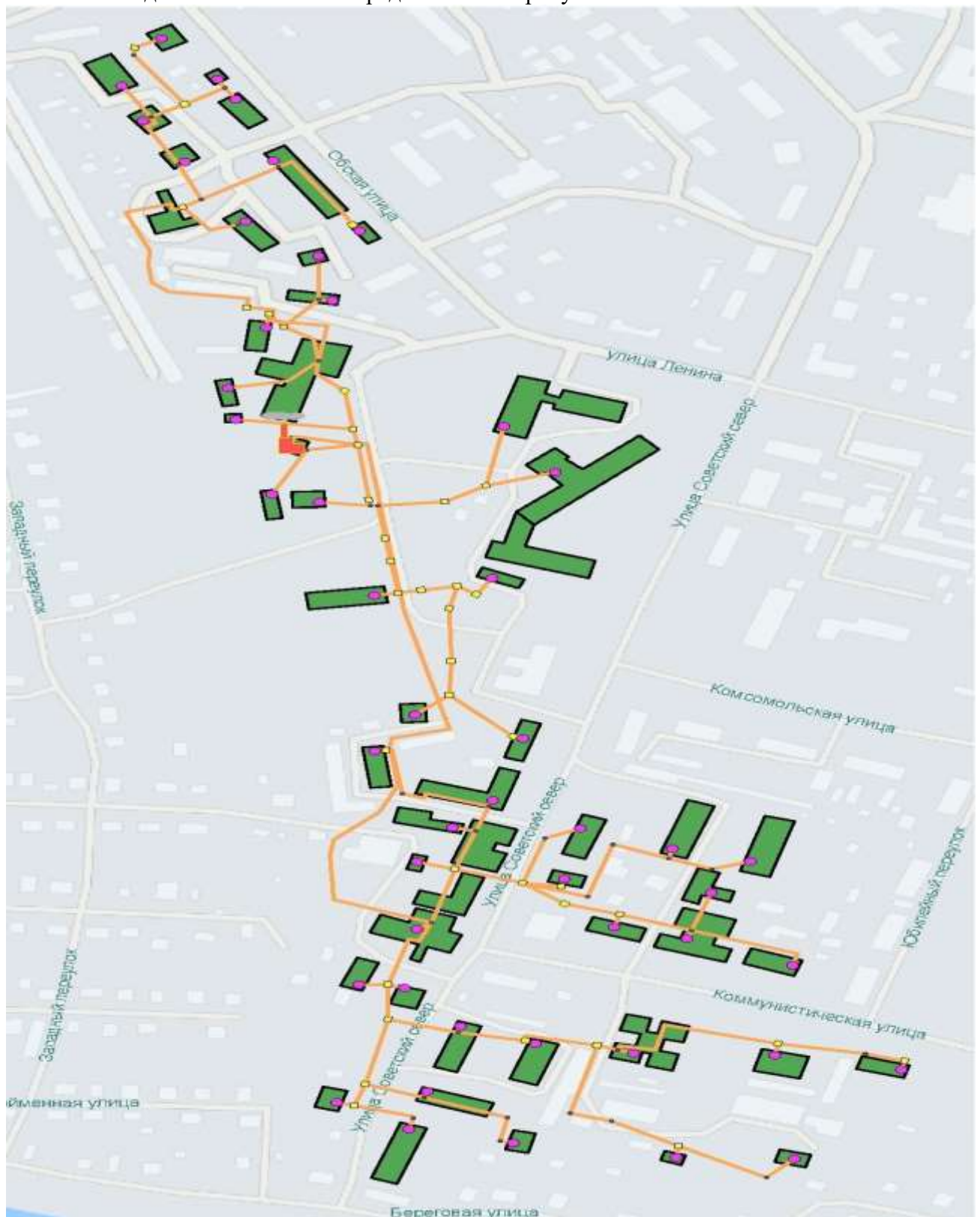
Рисунок 13. Зона действия котельной «ЦРБ».
