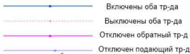
Рис. 3.4. Режимы работы трубопроводов
