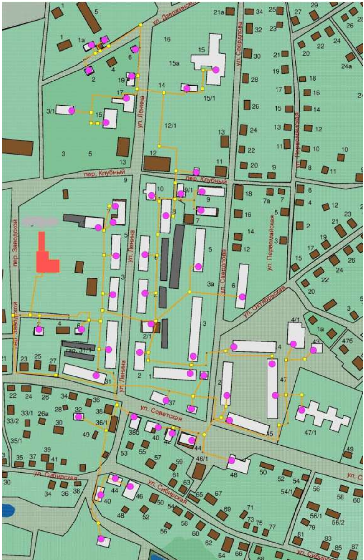
Рисунок 22. Зона действия котельной «Заводская».
