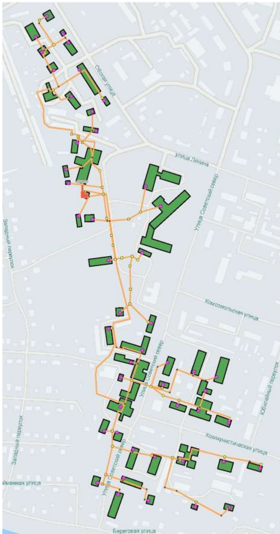
Рисунок 40. Схема тепловых сетей котельной «ЦРБ».
