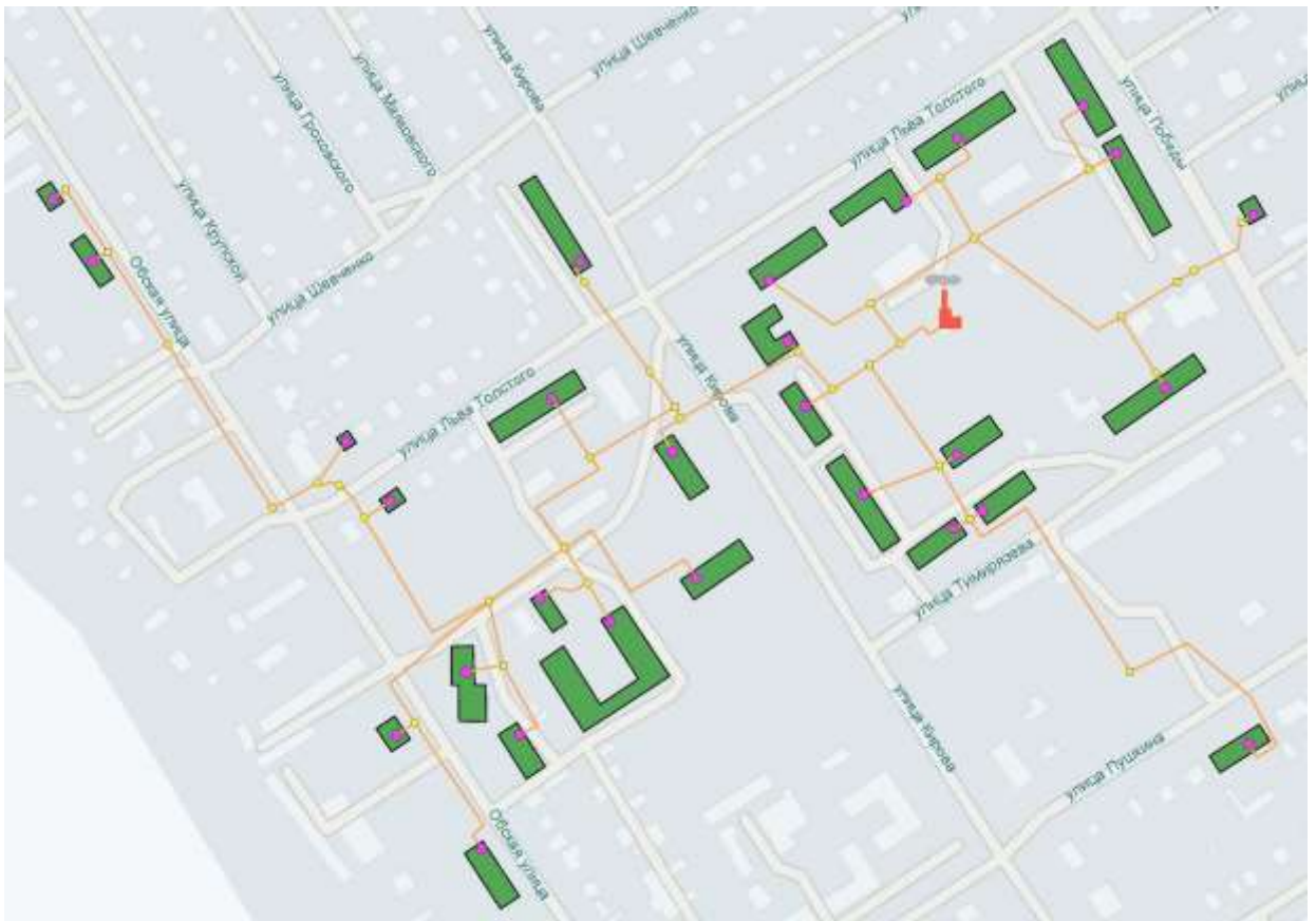
Рисунок 44. Схема тепловых сетей котельной «Победы».
