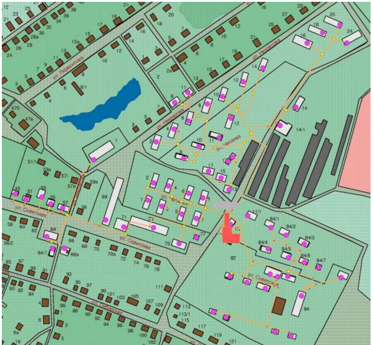
Рисунок 19. Зона действия котельной «Детский дом».
