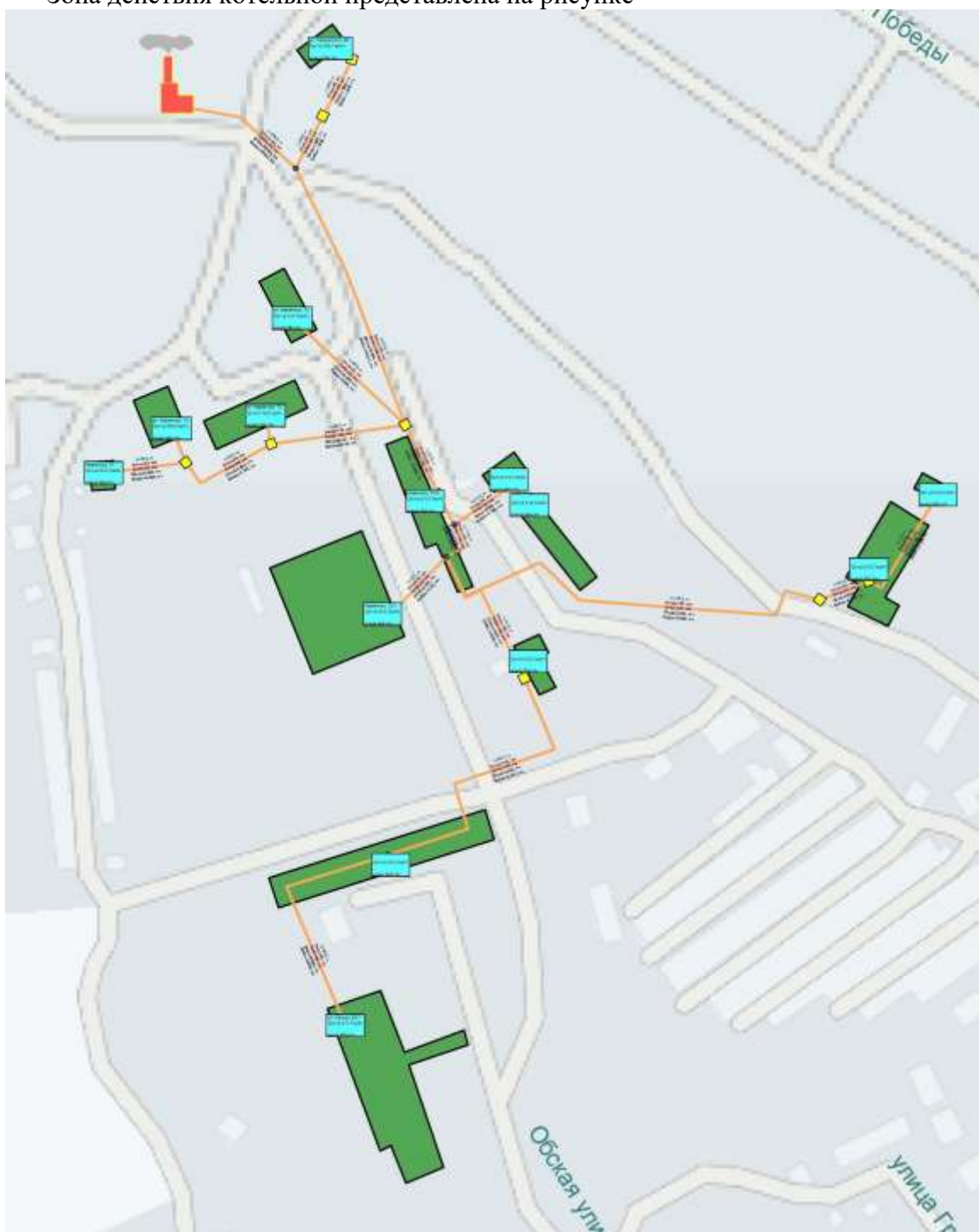
Рисунок 93. Зона действия котельной «РТП».
