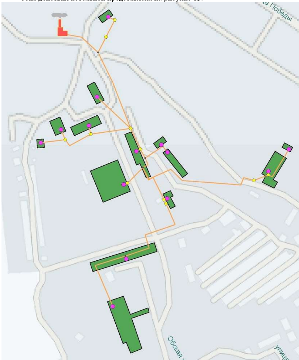
Рисунок 15. Зона действия котельной «РТП».
