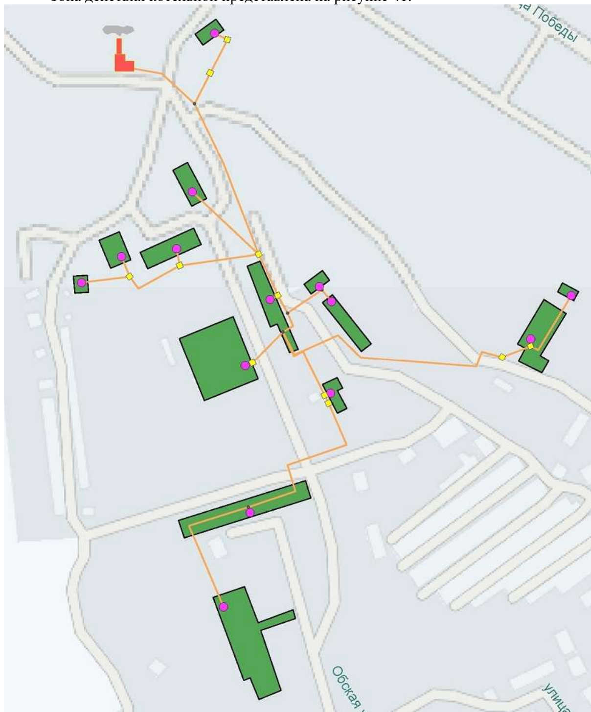
Рисунок 41. Схема тепловых сетей котельной «РТП».
