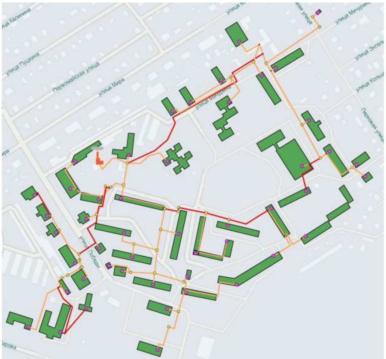
Рисунок 103. Участки предлагаемые к реконструкции. -Котельная ЦРБ
